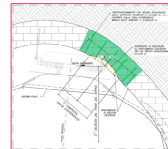
Interventi puntuali di fresatura del rivestimento
