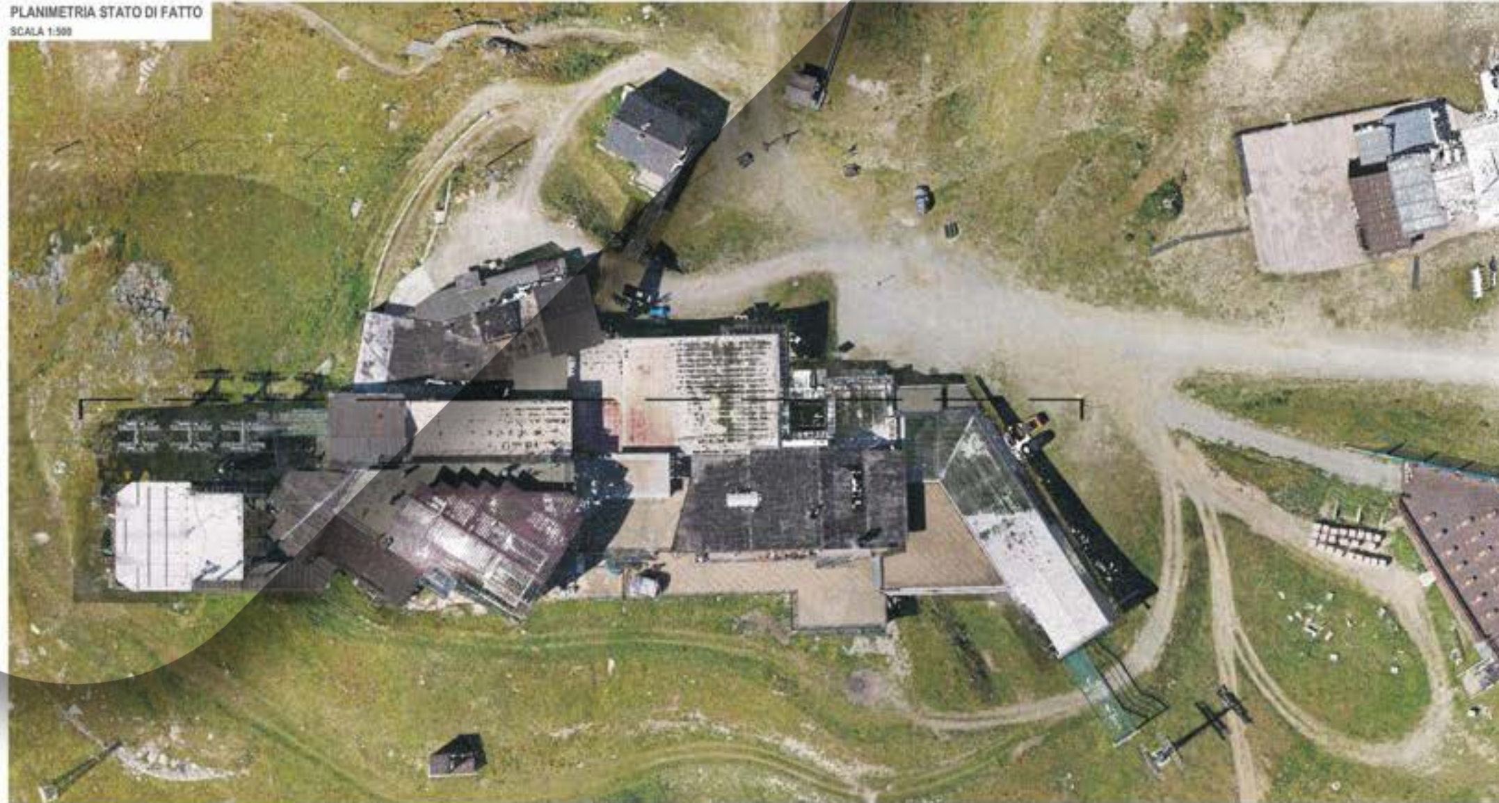
VISTA D'INSIEME DELL'AMBITO D'INTERVENTO NUVOLE DI PUNTI OTTENUTE TRAMITE SCANSIONI E RILEVI ESEGUITI CON LASER SCANNER 3D E RILEVI LIDAR DA DRONE
